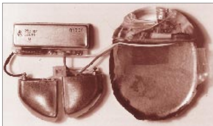
Die Bestandteile eines Herzschrittmachers Fotos: Olaf Cisek
