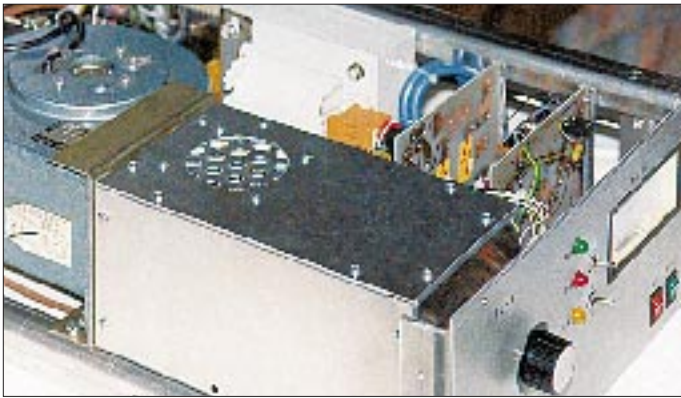
Bild 10: Ansicht von unten/hinten. Zu sehen rechts der Lüfter, vorn der Endstufentopf, oben in der Mitte der Hochspannungstransformator, darunter der Katodenkasten, links oben die Leiterplatten für die Hochspannungsgleichrichtung und die Steuerung
